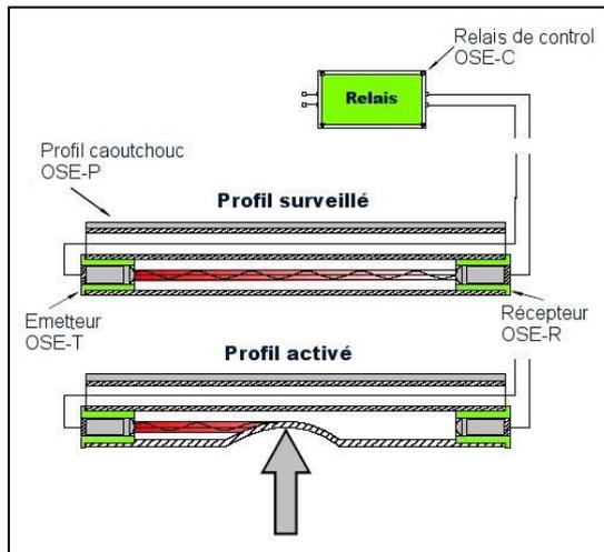
L'ensemble profil caoutchouc, cellule et relais de contrôle assure une protection tactile efficace.
